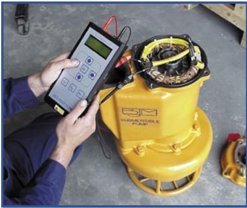
Probando el estado eléctrico de una combinación motor/bomba, le permite tomar una mejor decisión de reparación ó remplazo.
