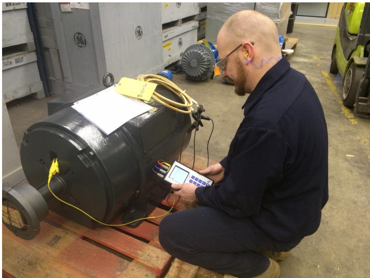
Erik Lehman, Técnico de Servicio de Koontz-Wagner, utiliza el ALL-TEST PRO 5™ para realizar la inspección inicial de un motor de 50Hp en el taller de reparaciones.
