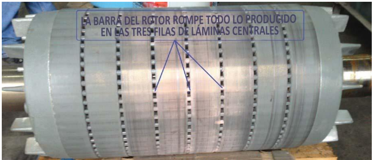
La barra del rotor rompe todo lo producido en las tres filas de láminas centrales.
