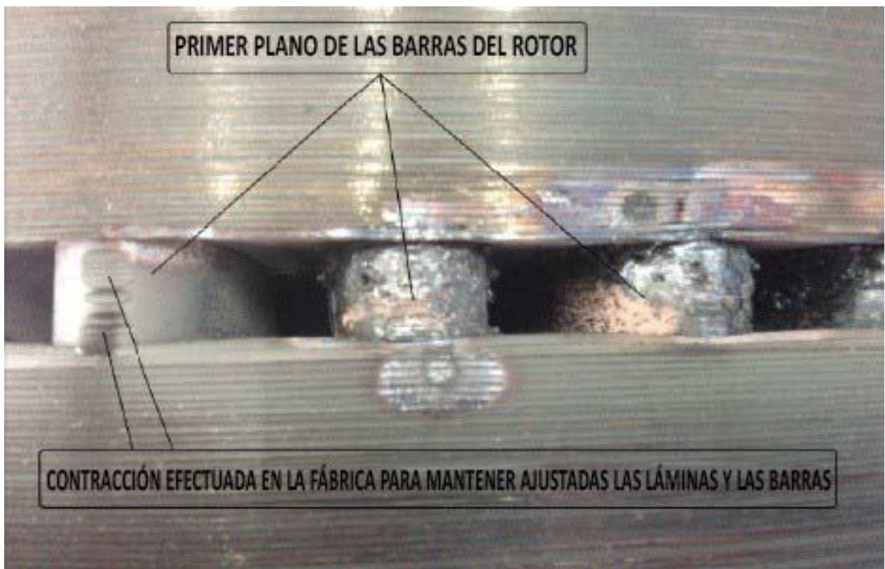
La barra del rotor rompe todo lo producido en las tres filas de láminas centrales.
