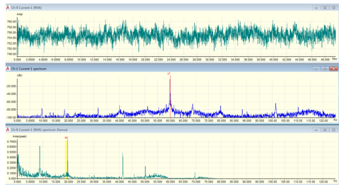
Figura 4. 5 de mayo de 2015 - Análisis de firma eléctrica utilizando el ATPOL II™ - (después de la reparación) la frecuencia de paso de polos desapareció y el consumo de corriente era de 754 amperes modulándose a 2 amperes.
